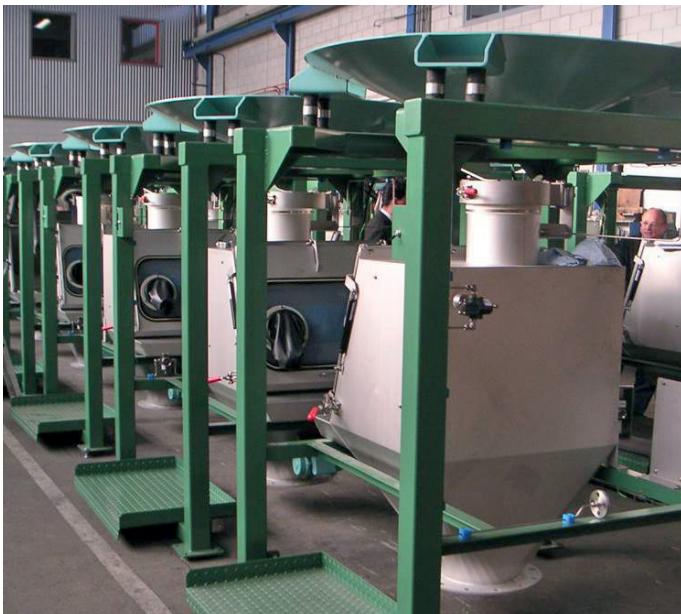
Bulk Bag-Entladestationen in Kombination mit Sackentleerstationen für eine PE-Anlage
