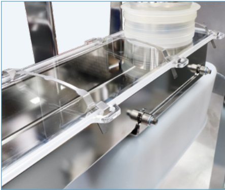
Dank speziellen Klemmen lässt sich der Rinnen-deckel schnell lösen.
