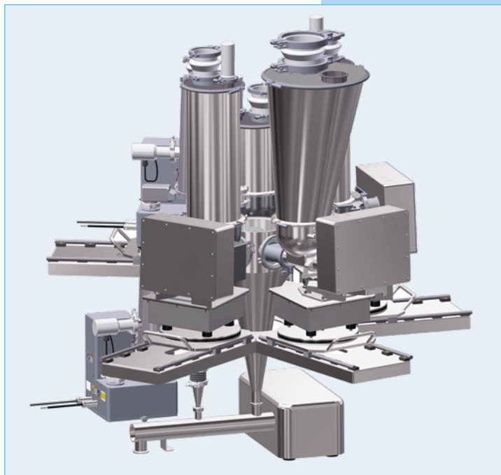
連続生産用にデザインされたスライドレール上に設置した5台のK3-PHフィーダーを連続ミキサー上に配置
