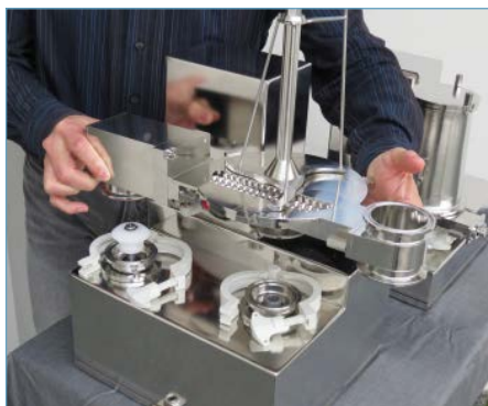
Abbildung 6: Das Dosiermodul des Coperion K-Tron Mikrodosierers kann einfach und werkzeuglos ausgetauscht werden
