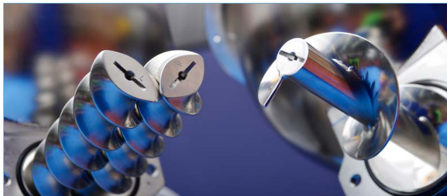
Abbildung 1: Doppel- und Einzelschneckendosierer werden für das Dosieren verschiedenster Rohmaterialien eingesetzt.
