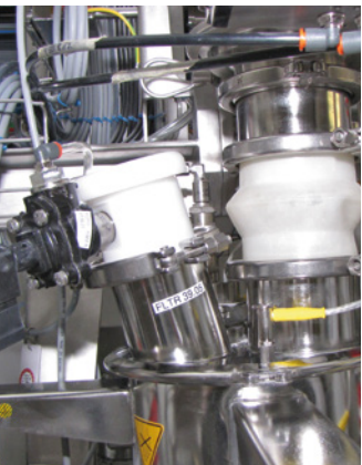
Foto 3: Coperion K-Tron hygienegerechter Abreinigungsfilter für Differentialdosierer
