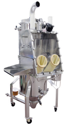
Foto 2: Sackschütte in hygienegerechter Ausführung mit Glovebox
