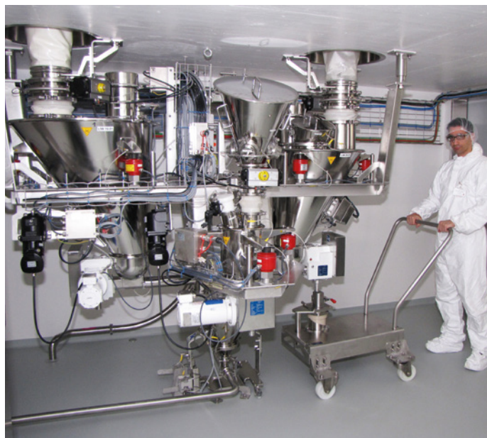
Foto 7: Kontinuierliche Produktionslinie für Säuglingsnahrung mit mehreren Dosierern, komplett mit integrierter Offline-Wägung für Probenahme sowie Validierung und Kalibrierung der Dosierer.
