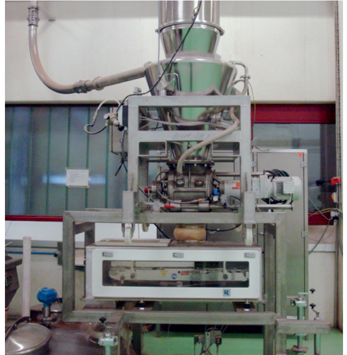
Dosierbandwaage mit Vakuumabscheider, Puffertrichter und Zellenradschleuse zur Vordosierung.
