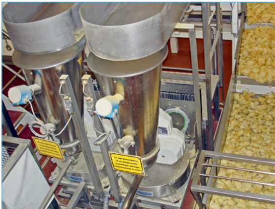
Dosificadores de Coperion K-Tron en un proceso de aperitivos
