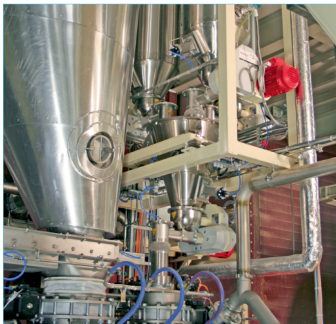
Dosificadores de Coperion K-Tron en un proceso de recubrimiento de alimentos para mascotas
