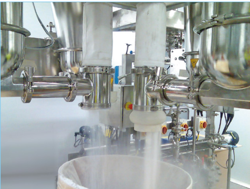
コペリオン K-トロンのファーマタイプフィーダは、扱いの難しい粉体も高精度に安定供給できます
