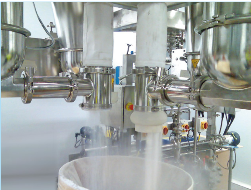
Coperion K-Tron Pharma-Dosierer sind selbst für die Dosierung schwieriger Pulver ideal.
