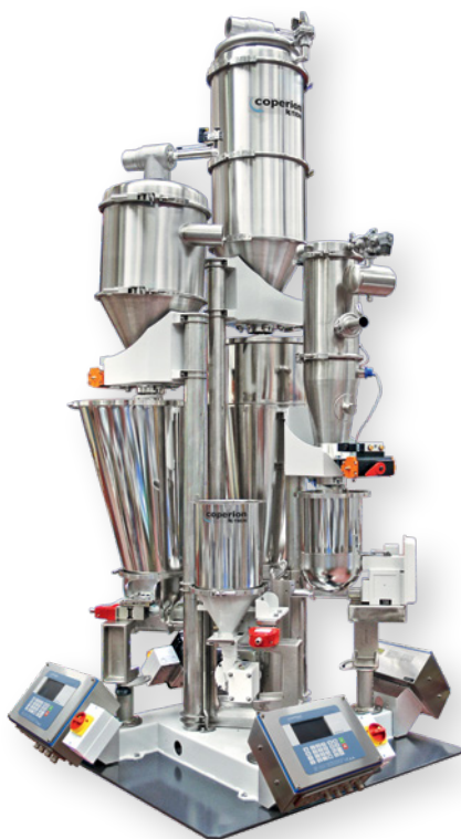
K4G 重量式ブレンダー プラスチックのコンパウンド や押出機のアプリーショ ン用に設計されたシステ ムで、6台までのフィーダをコ ンパクトに設置することがで きます。 供給範囲: 0.5- 2,388 L/hr
