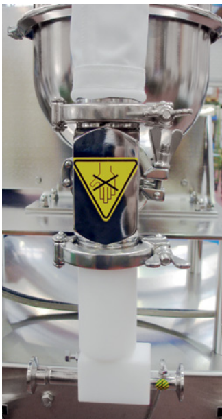
Dosierer-Auslauf mit Venturidüse
