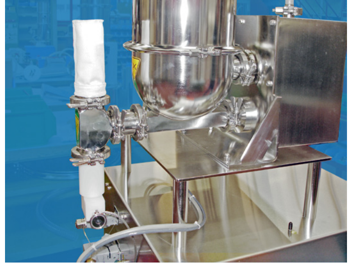
Volumetrischer Pharma-Dosierer mit Venturidüse am Auslauf
