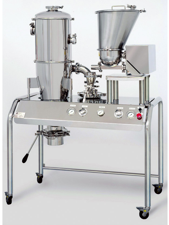
JetPharma Spiral-Strahlmühle mit Coperion K-Tron Dosierer
