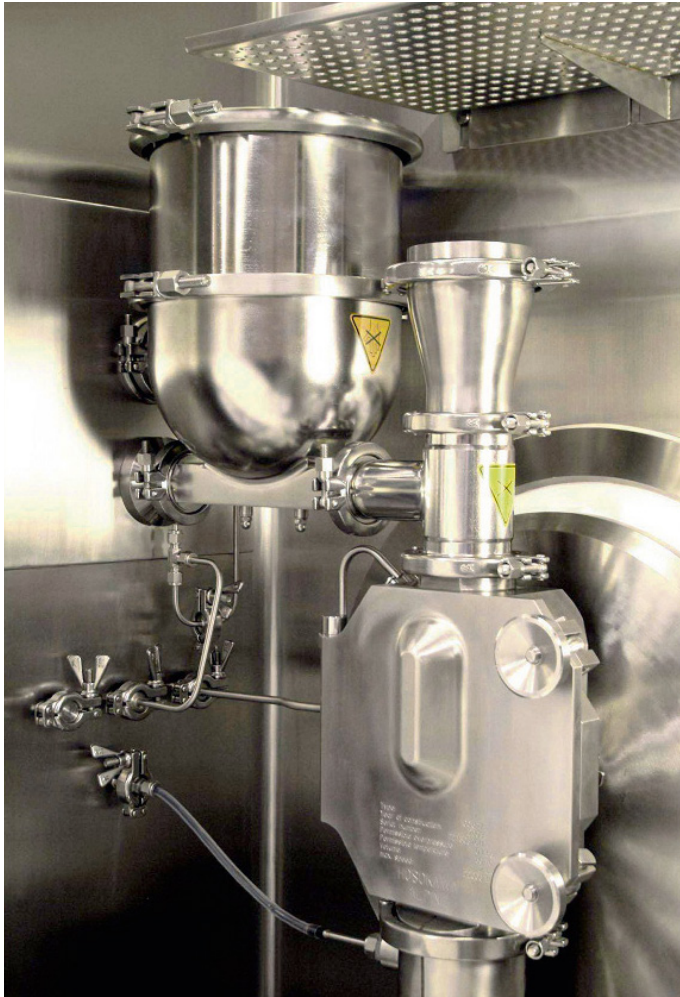
Coperion K-Tron Dosierer mit Hosokawa Alpine UPZ Stiftmühle in Isolator
