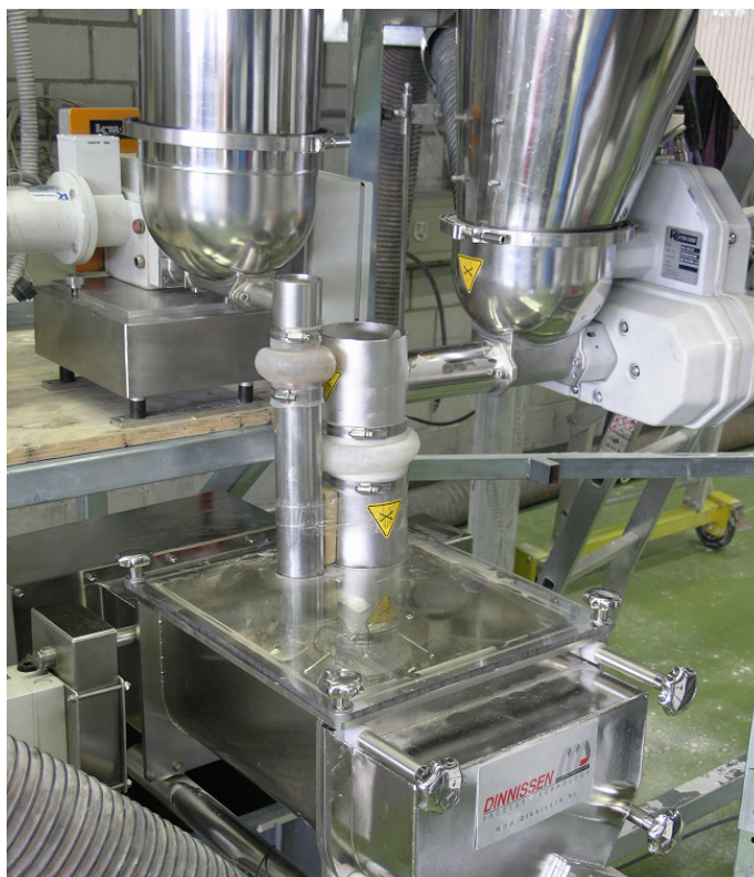
Foto 2: Coperion K-Tron Dosierwaagen im Einsatz mit einem Mischer
