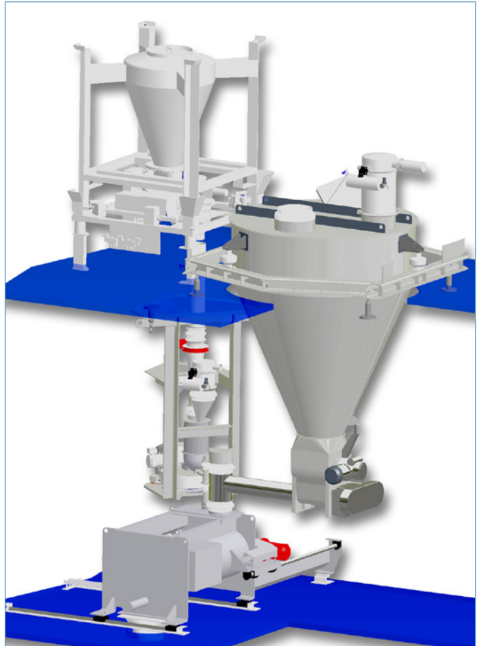
Fig. 5: Dosierwaage mit Nachfüllung über kontinuierlichem Mischer
