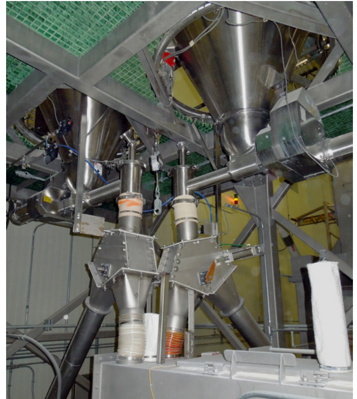
Foto 1: Coperion K-Tron Differentialdosierer dosieren Gewürze in einen kontinuierlichen Mischer
