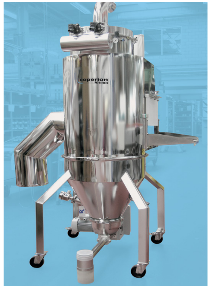
Geschlossene Sackentleerstation für Probiotika, mit Dosierer als Austragsseinheit für den Einsatz in einem GIW-Chargensystem
