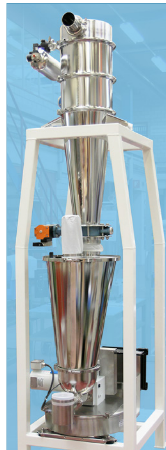
Differentialdosierer mit Vakuumabscheider der P-Serie
