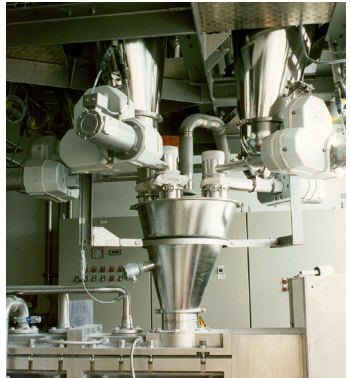
6. Eine Mehrfach-Extrusionsanwendung mit flankierenden Einzelschnecken-Extrudern, die direkt in den Spritzkopf fördern.
